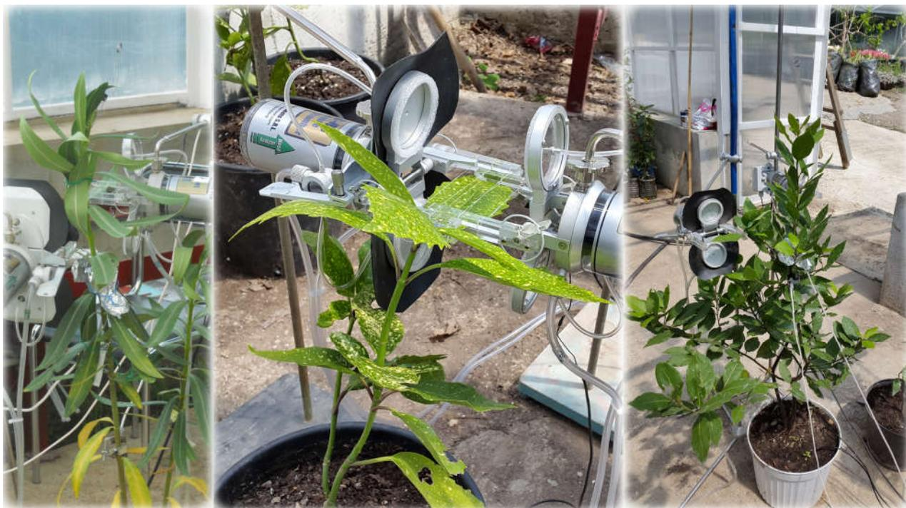
Рисунок 2.4 – Измерение параметров  $\text{CO}_2/\text{H}_2\text{O}$ -газообмена в условиях вегетационного опыта
