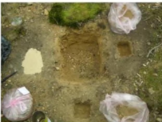
3. Определение объема лунки с использованием песка
