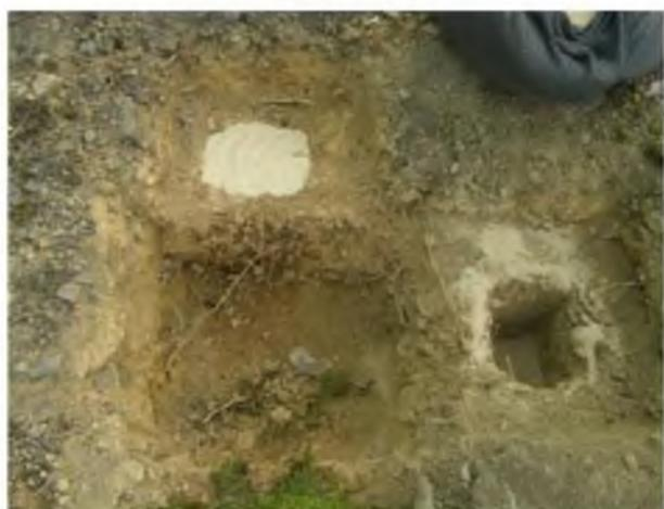
6. Определение объема лунки с использованием песка в горизонте 10 - 30 см.
